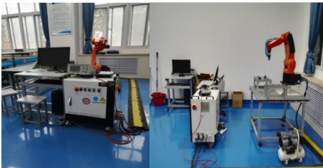
易拆装检测用工业机器人 III 型
